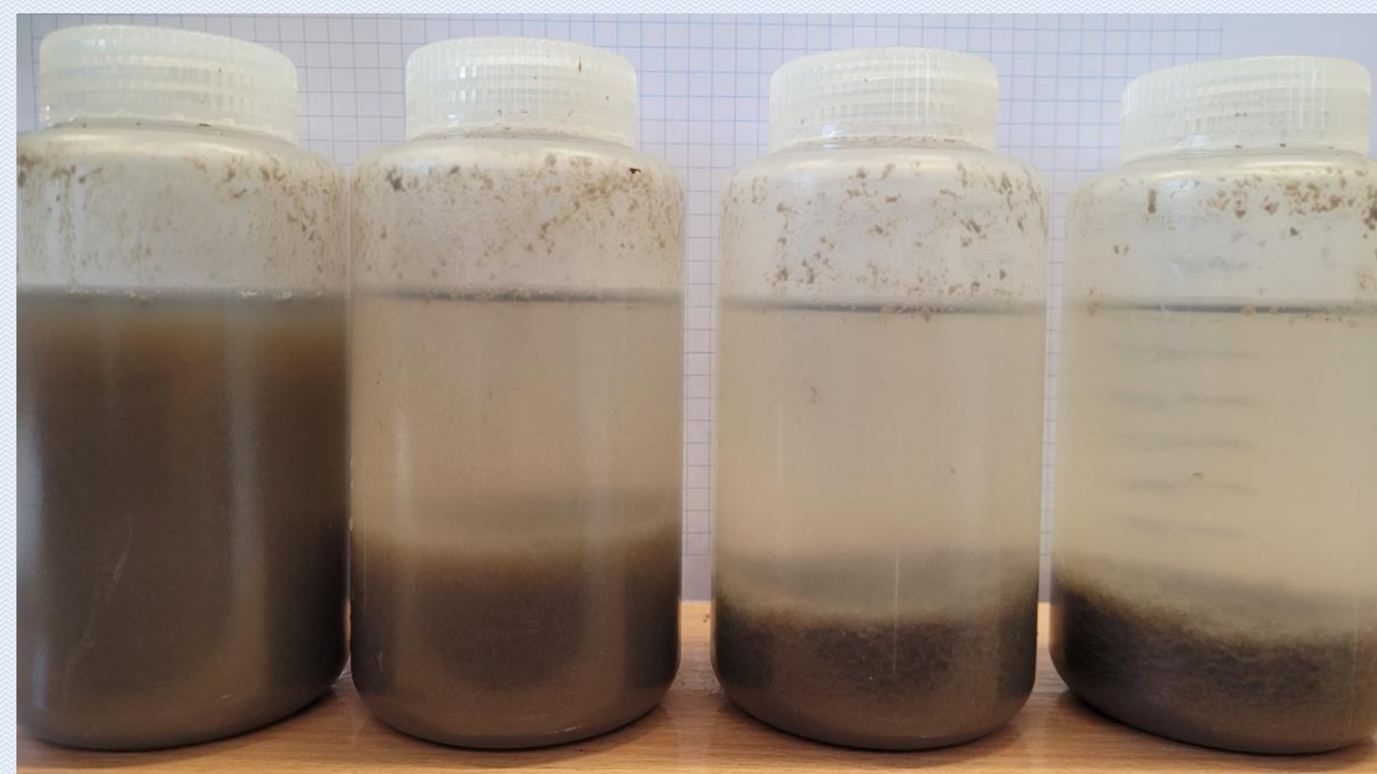
Rysunek 2. Osad nadmierny po odwadnianiu mechanicznym na wirówce w kolejności wzrastającej dawki flokulantu.
